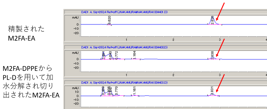
図4 精製された M2FA-EA と M2FA-DPPE から加水分解された M2FA-EA
