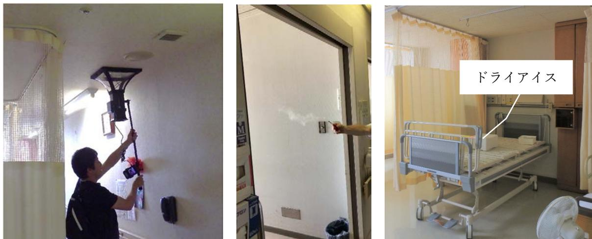
写真 1 調査の状況 (風量測定 スモークテストによる気流測定 CO<sub>2</sub> による換気測定)
