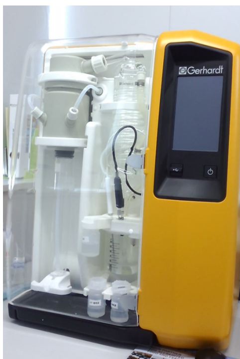
図 3 自動蒸留滴定装置 (VAPODEST 500, ゲルハルトジャパン株式会社製)
