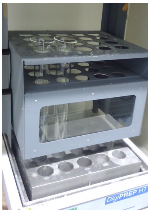
図 2 加熱分解装置((DigiPREP HT250-20, 株式会社 SCP SCIENCE 製)
