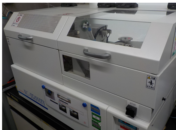
図4 改良デュマ法で用いた装置 ((SUMIGRAPH NC-TRINITY, 株式会社住友分析センター製)
