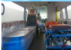
運転手の後方にビニールシートの仕切り乗務員はタイベックスーツ着用患者が座る部位もビニールで保護
