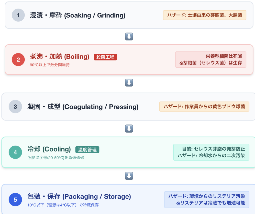
図2 豆腐製造工程におけるハザードとその管理ポイントの提示例
