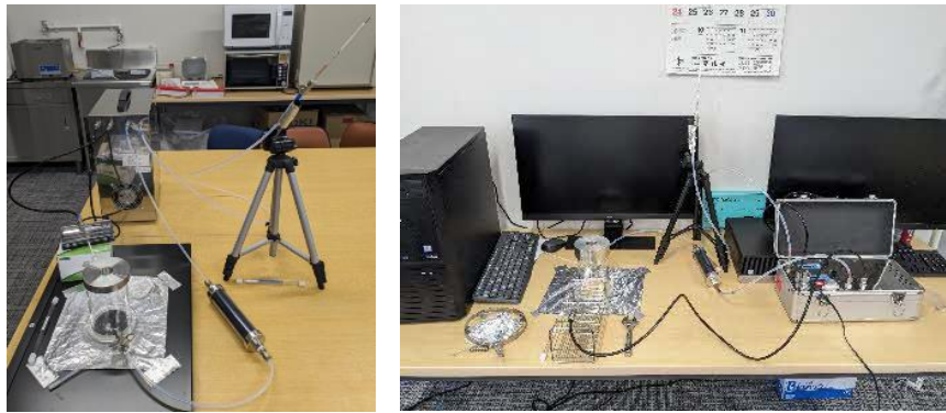
図1 家具・家電製品からの放散速度の測定様子
