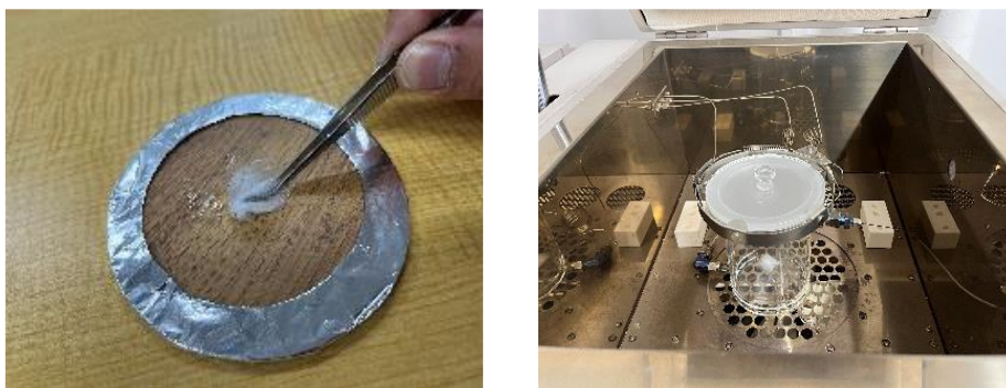
図3 表面ブリードアウト濃度の測定様子と加熱脱着様子
