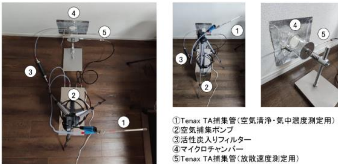
図 9 壁面におけるオンサイト試験法の測定様子
