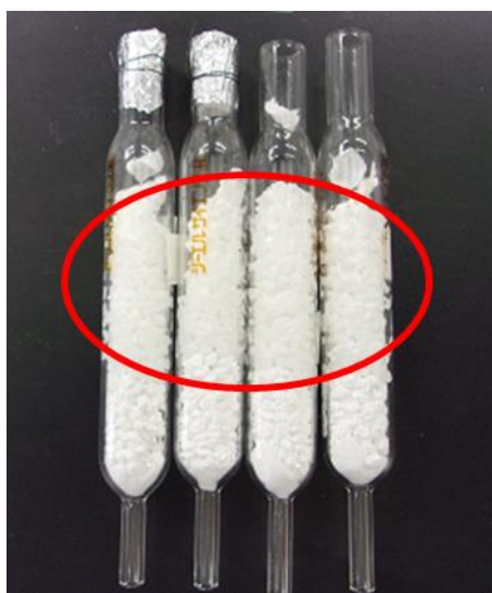
Fig. 9 自作除湿管F（赤丸内が潮解した部位）
