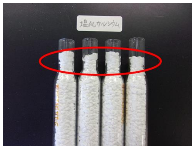
Fig. 7 自作除湿管E（赤丸内が潮解した部位）
