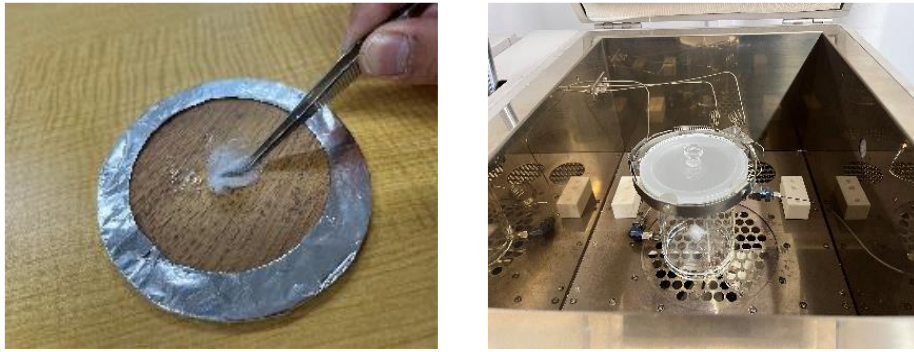
図5 表面ブリードアウト濃度の測定様子と加熱脱着様子
