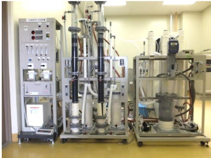
図 3. 小型高度浄水処置装置
