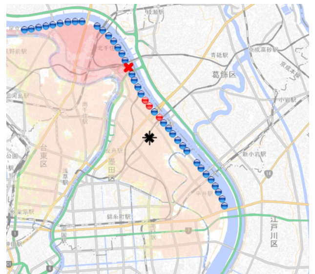
図7. 浸水ナビによる荒川下流域におけるデータ抽出: ●仮想破堤場所(破堤そのもののリスクに基づくものではなく、河川を網羅的に解析するためにプロットされたもの); ●仮想病院の位置(*)に最大浸水深をもたらず仮想破堤場所; X実際に破堤リスクの高い場所(京成本線荒川橋梁近)
