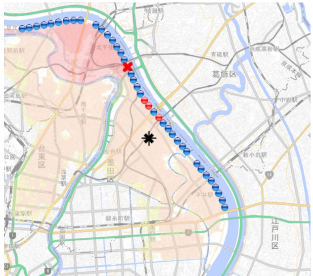
図2. 浸水ナビによる荒川下流域におけるデータ抽出: ● 仮想破堤場所(破堤そのもののリスクに基づくものではなく、河川を網羅的に解析するためにプロットされたもの); ● 仮想病院の位置(*)に最大浸水深をもたらす仮想破堤場所; ✕ 実際に破堤リスクの高い場所(京成本線荒川橋橋梁近)
