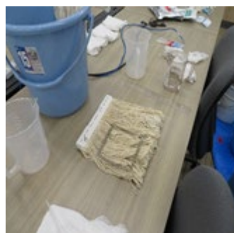
写真 16 モップのATP測定 (表面、絞り液のATP値も測定)
