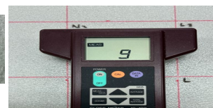
写真5 3種類のアクリル板の光沢度
