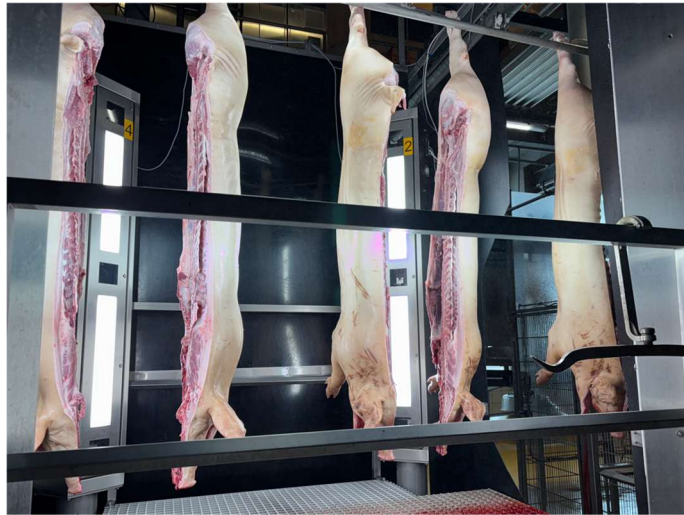
図 6. デニッシュクラウン社ホーセンスと畜・加工場に導入されている豚枝肉の Vision システム.
