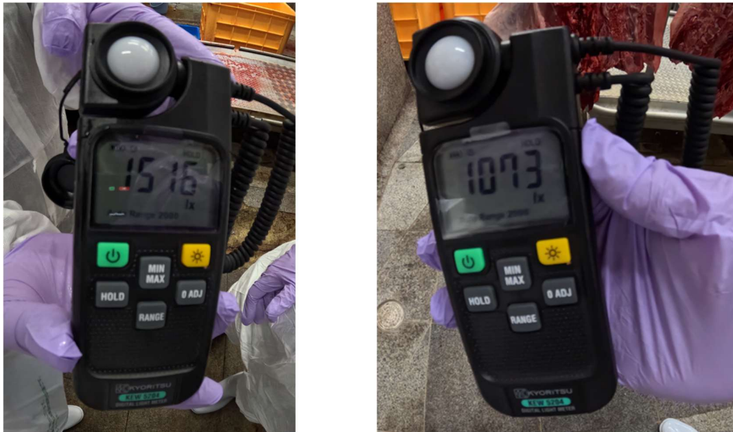
図9. 食肉検査所内での照度測定の結果.
