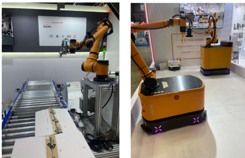
図C-(2)-2-23 段ボール開梱システムとAMR複合ロボット
