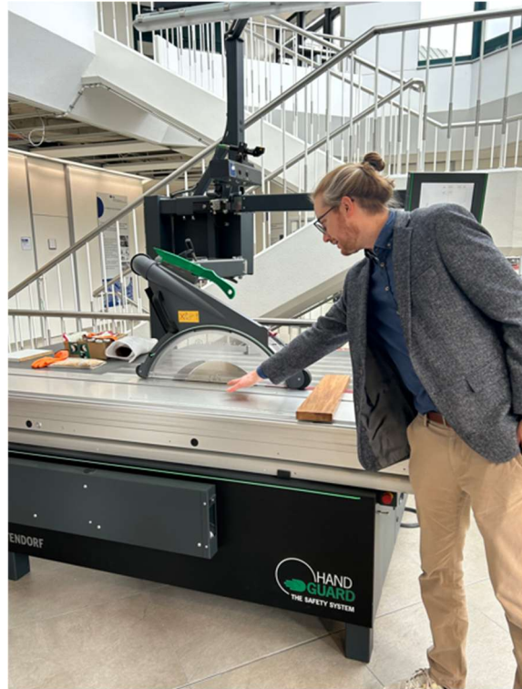
図C-(2)-3-9 AIカメラ情報を用いた丸鋸盤の実際
