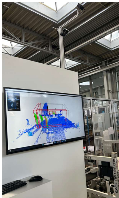
図C-(2)-3-18 3D-LiDARで人検出するアプリケーション
