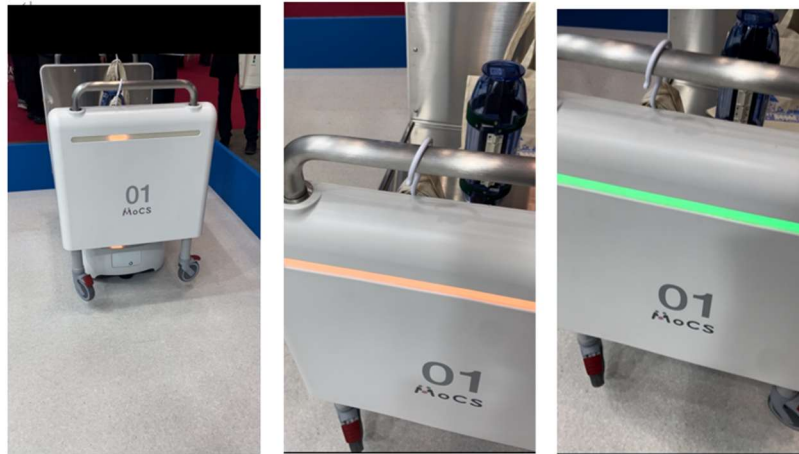
図C-(2)-2-12 接触安全機能を付加したAMRとランプ表示によるマンマシンインターフェース向上
