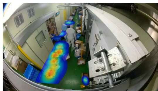
図 3-2. 作業環境内の重量物マッピング
