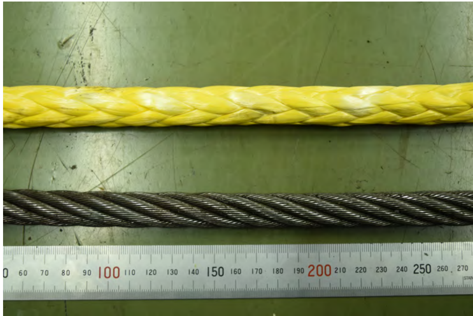
図1 本研究で対象としたワイヤロープ (IWRC 6×Fi(29)) および繊維ロープ (エースライン SUHD026B) の外観
