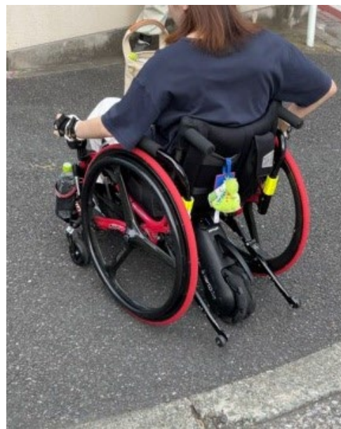
図2 アシストありでの縁石の切り下げ部の走行 同一条件下において自走が可能となった。
