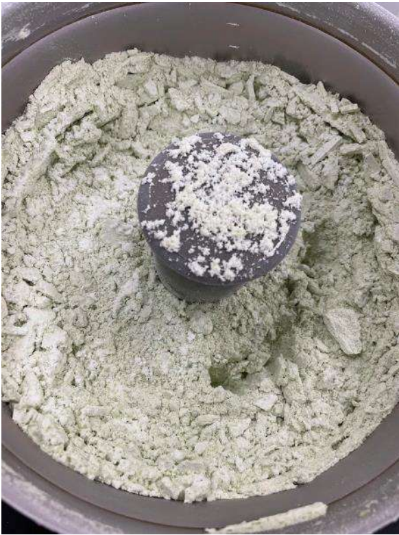
Fig 3. 凍結粉碎試料の均質化状態（左：調製作業時，右：解凍時）
