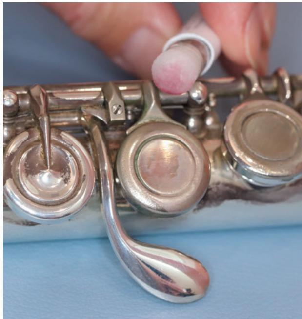
図30 金属アレルギー発症例に使用されていたフルートキイ（指が接するパート）より、ニッケルの溶出が確認された。
