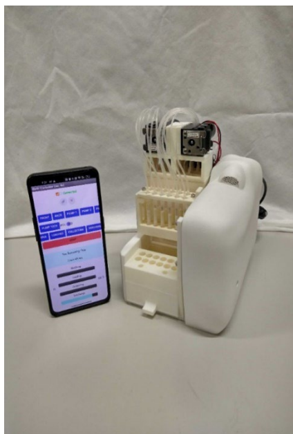
図1. エナメル質用の可搬式自動前処理装置 (Elefit)
