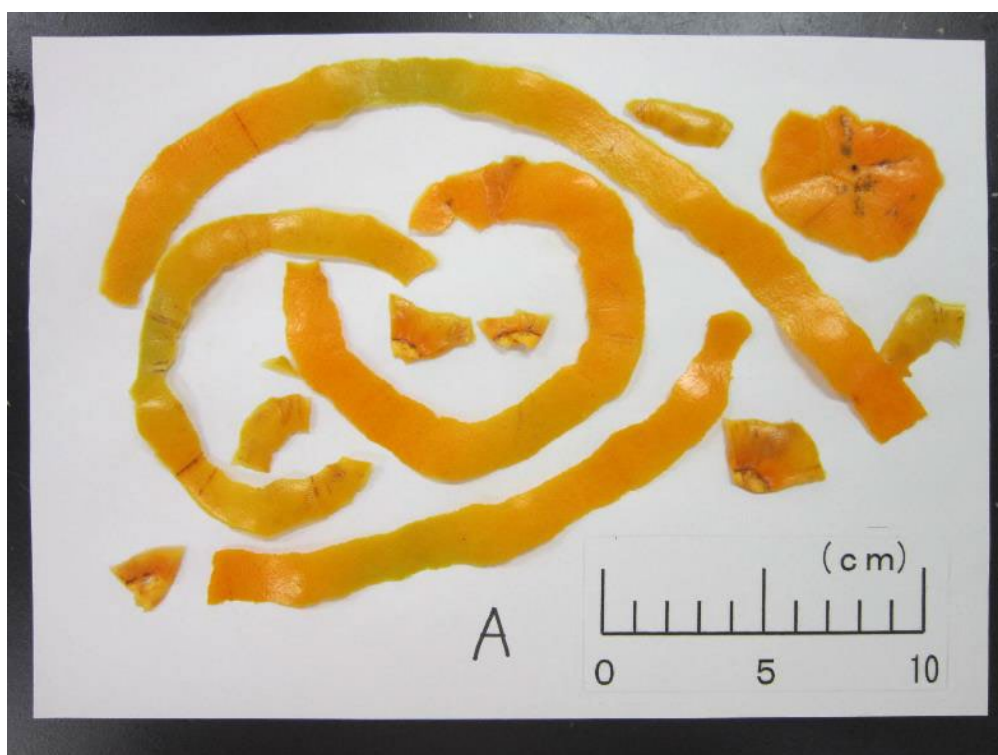
付録2 ピール法による表面積計測
