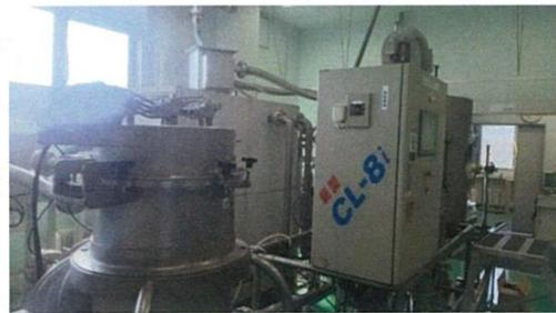
図1 窒素ガス密閉循環型スプレードライヤCL-8iの外観
