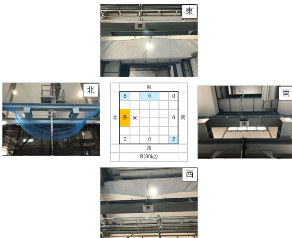
図4 実験 No. 2 の結果（8 点固定のネットに 90 kgの重錘を落下させた場合：B 社製）
