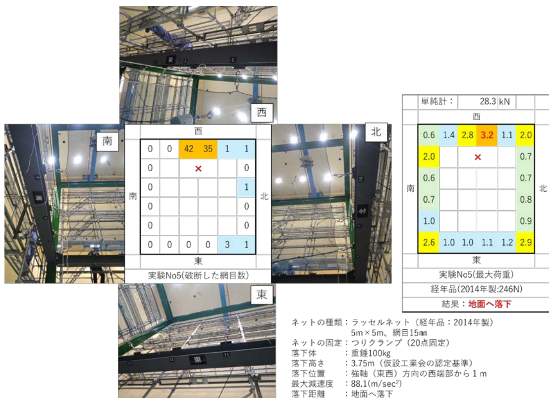
図9 20点固定（経年品、西側端部1mへの落下）の結果
