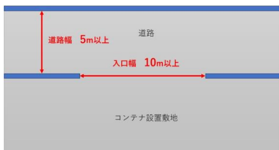
図3 医療コンテナ搬入トレーラーの必要な経路幅（例）
