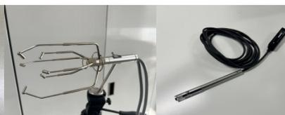
(a) 超音波風速 (b) 熱線風速計
