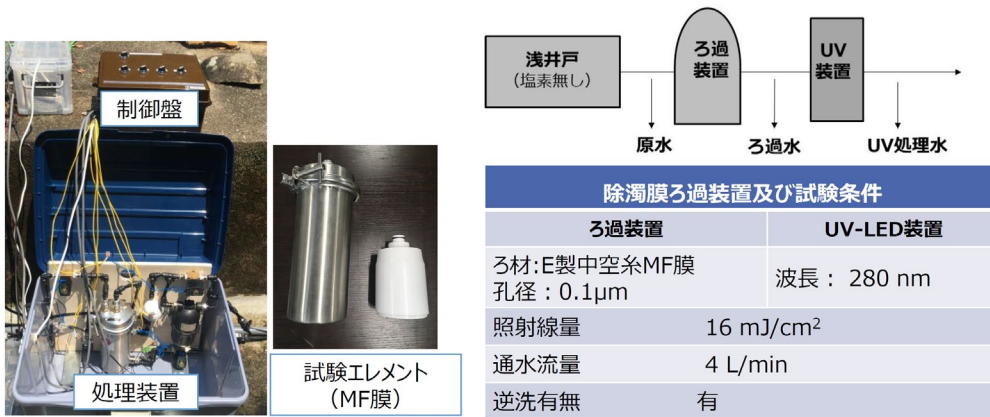
参考1 各戸における小型所濁膜ろ過、UV-LED装置及び試験条件
