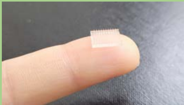
スタンフォード大学とノースカロライナ大学 による3Dプリントされたマイクロニードル ワクチンパッチ
