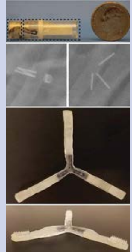
上から: カプセル化された LUMI。アームが拡張する前(左)と後(右)の腸内の薬物送達カプセルを示すX線画像。展開されたLUMIの頭上と側面の画像。エイブラムソンら、 Nature Medicine
