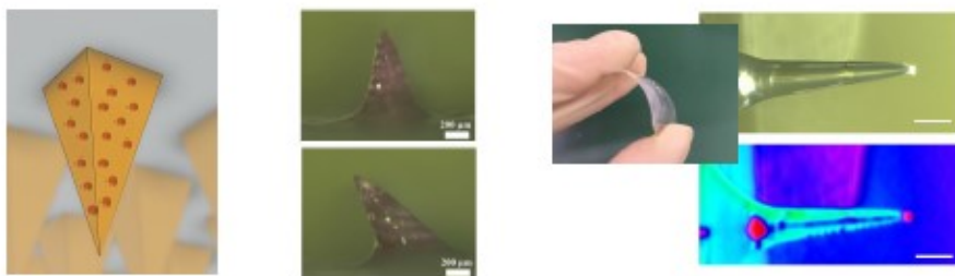
液滴込みニードル コーティッドニードル 光セラピー用マイクロニードル
