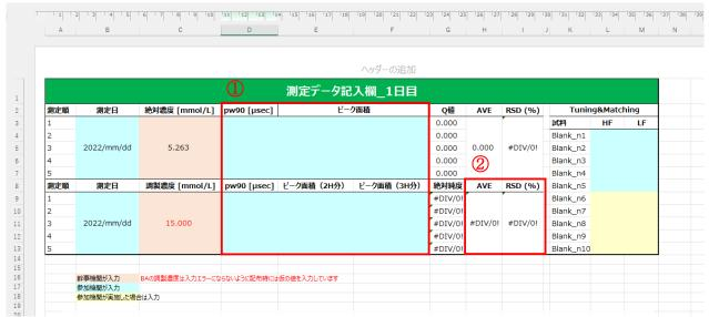
EC 及び BA の pw90 とピーク面積を入力すると(①)、BA の定量結果が得られる(②)。 ただし、BA の調製濃度は仮の値を入力している。不確かさが付与された BA の調製濃度は、共同試験終了後に公表する。
