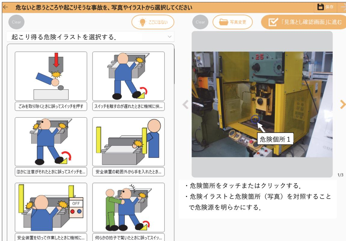
図 19 試作したアプリケーションによる危険源同定
