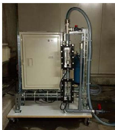
図3 オゾン供給装置 （ろ過器のオゾン消毒）
