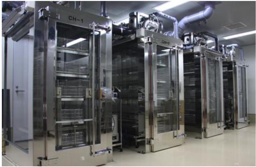
Photo 1 ガス発生装置（左）と 3m3 横層流方式吸入曝露チャンバー（柴田科学）
