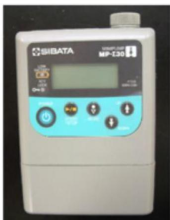
Photo 4 捕集管採気用ポンプ MP  $\Sigma$ -30、(柴田科学)
