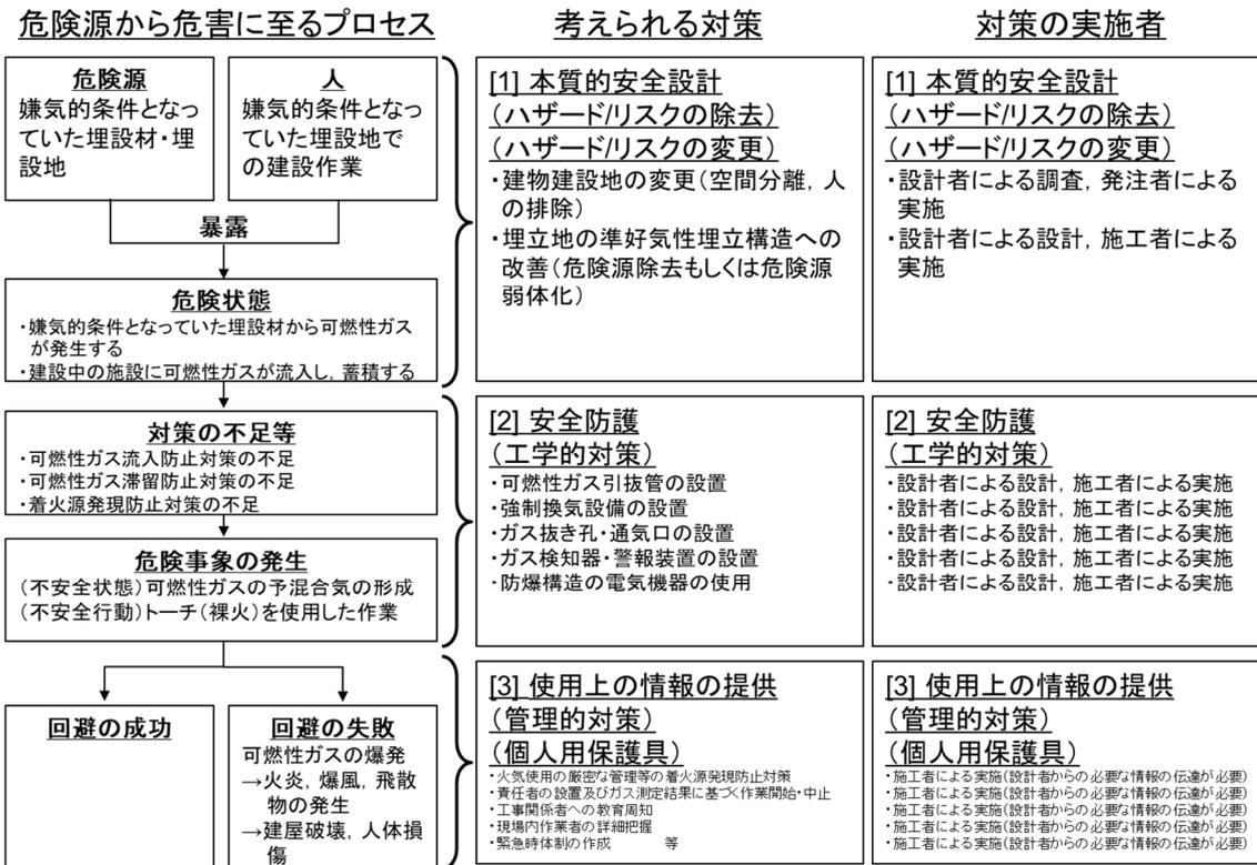
図2 建設地からの可燃性ガス発生による爆発災害における「危険源から危害に至るプロセス」
