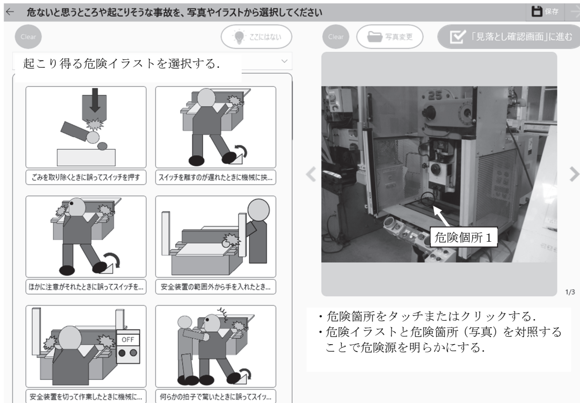
図26 試作したアプリケーションによる危険源同定
