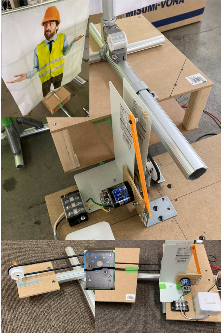
Fig.C-3-3.1 : 動的障害物の模擬装置
