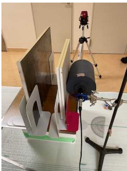
図 16 石膏ボードの透過割合の実験の様子
