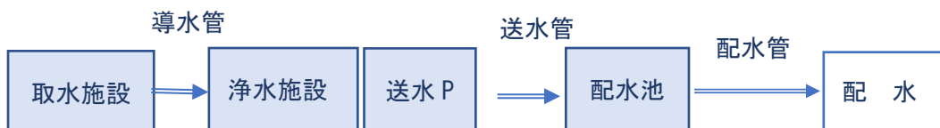
図 2.6 モデル地区の給水フロー図
