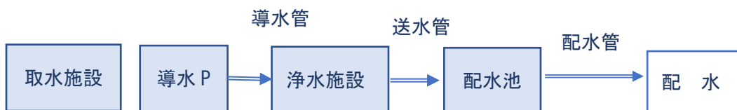
図 2.17 浄水処理フロー図
