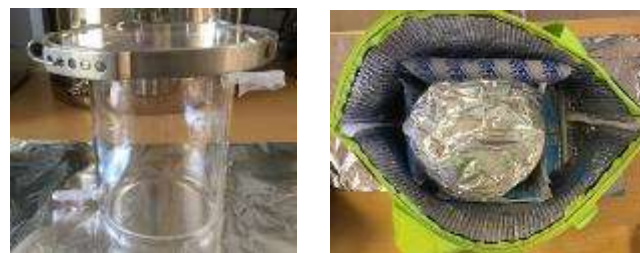
図6 トラベルブランク値実験の様子
