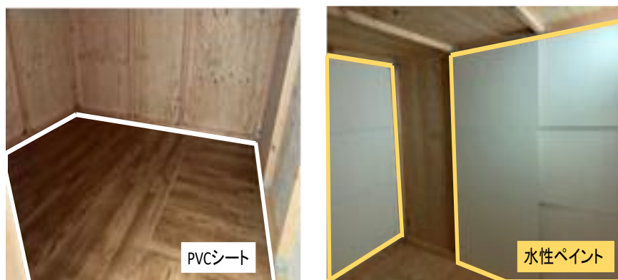
図 3. 実空間モデルの内部及び試験片の設置写真
