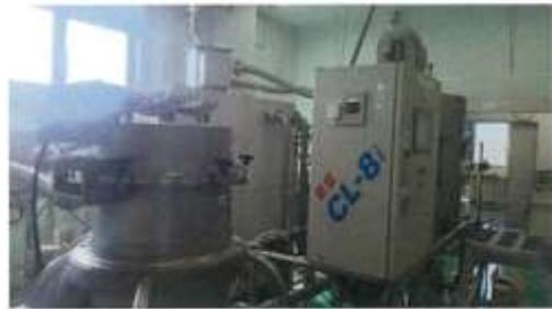
図2 窒素ガス密閉循環型スプレードライヤCL-8iの外観
