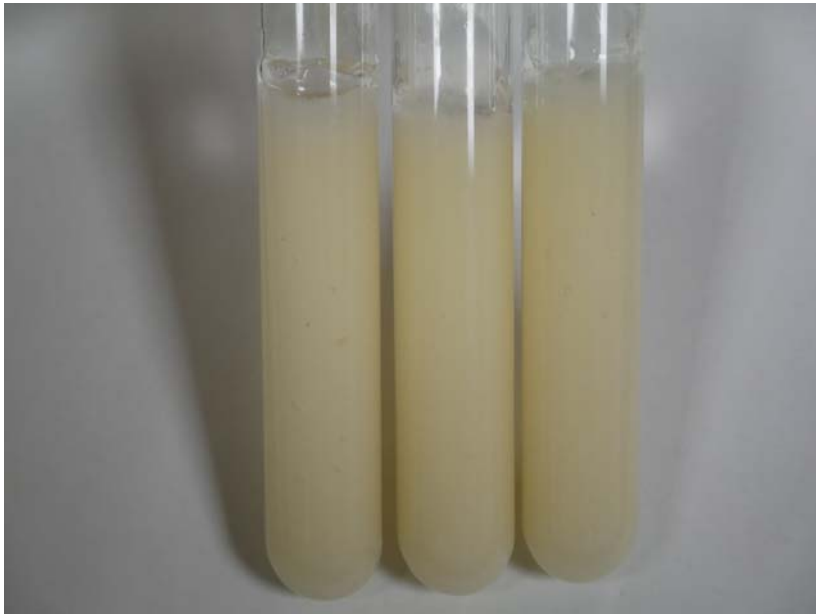
写真 5 恒温槽放置検体 10 時間後（若干のガス発生）
