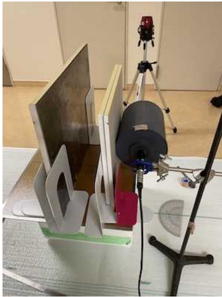
図 6 石膏ボードの透過割合の実験の様子
