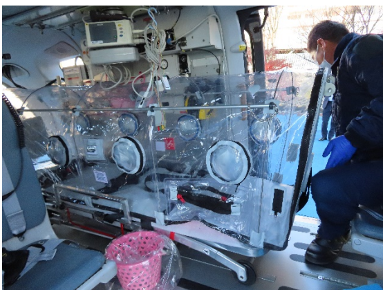
図10：チャンバーが座席方向に突出
