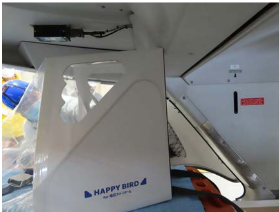
図 31：そのままでは EC135 の搬入口より高い 図 32：折り曲げて搬入
