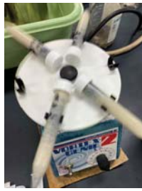
Vortex Adapterに装着し ボルテックス
