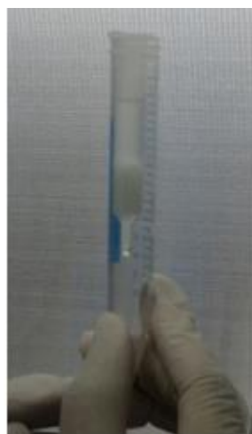
Solution SR5 をカラムに通しているところ (自然に落ちるのを待つ。カラムにより落下速度に差がある)
