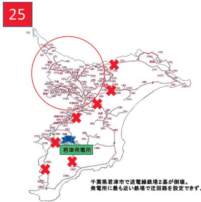
図7 千葉県の送電網と断線の模式図 (東京電力パワーグリッド HP より一部改変)
