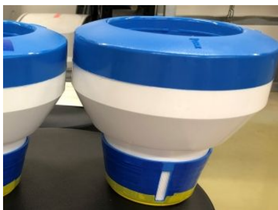
写真3 塩素溶解速度の調整例（外部）
