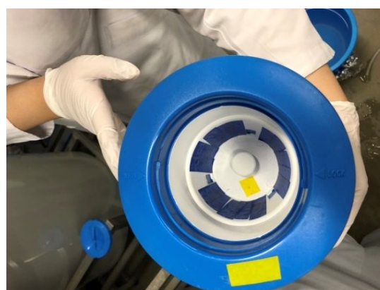
写真4 塩素溶解速度の調整例（内部）
