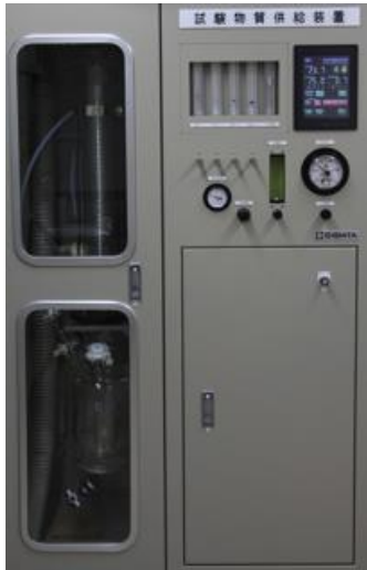
Photo 1 3m³横層流大型チャンバー及びその発生装置(柴田科学)
