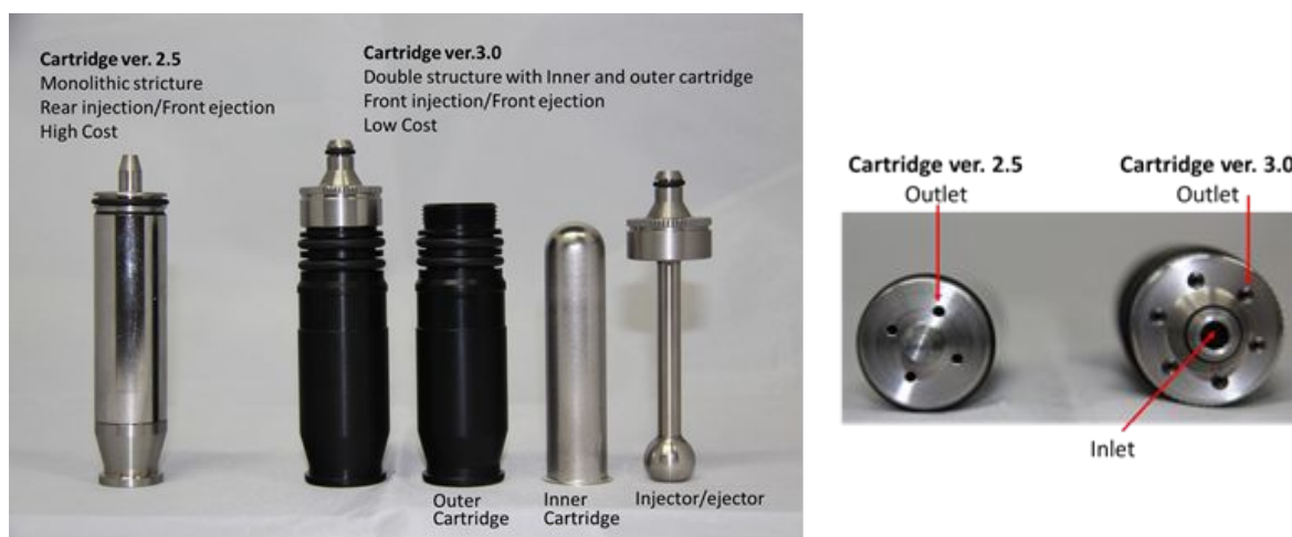
図 3 Taquann 直噴全身曝露吸入装置のカートリッジ
