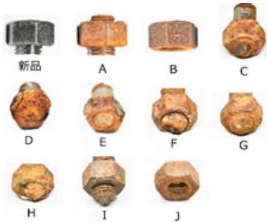
図2 サンプルとした減肉ボルト・ナット
