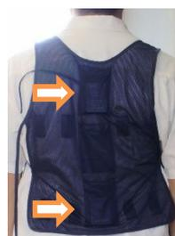
図 1.加速度計の装着部位
